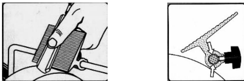
Pevný způsob zaaretování přípravku zlepšuje upnutí přípravku. Úhel broušení lze lehce nastavit a během chvíle znova zaaretovat.
