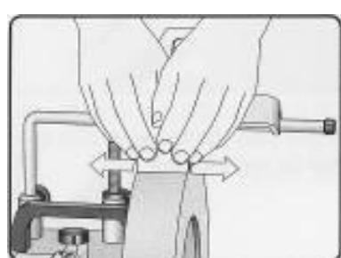
Použijte stejné nastavení a bruste 30-40 sekund. Netlačte tak silně.
