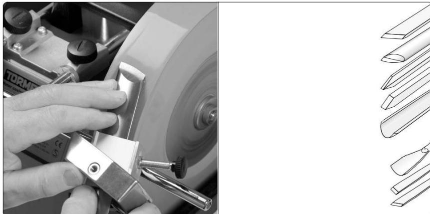
Tento přípravek se skládá z pouzdra (1) a dvou výměnných upevňovacích přípravků pro nástroje rovné (2) a pro oblé (3). Přípravky jsou otočné v rozmezí 0° - 45° pomocí nastavovacího kolečka (4). Soustružnická dláta se brousí z obou stran. Tímto přípravkem je možné pomocí jediného upnutí nástroje nabrousit obě strany pod stejným úhlem pouhým otočením.
