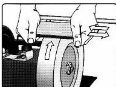
Pokud dojde při broušení k vyhlazení kamene, je nutné použít SP – 650 (kámen na úpravu zrnitosti) k dosažení optimální hrubosti kamene.
